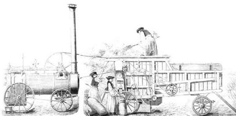
A meghajtó gőzgép és a cséplőgép (1856)
